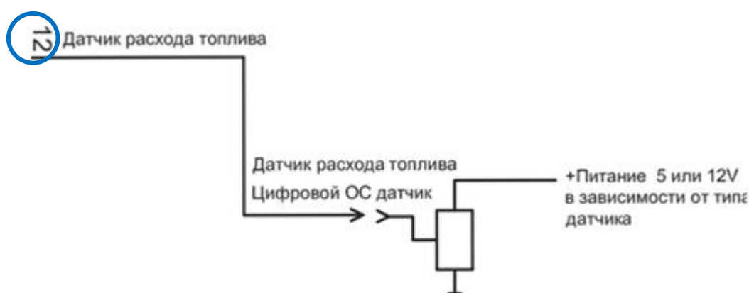
Рис.2.10.1. Электрическая схема подключения расходомера топлива
