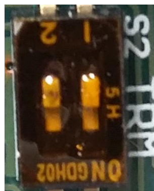
Микропереключатель для выставления номера устройства
